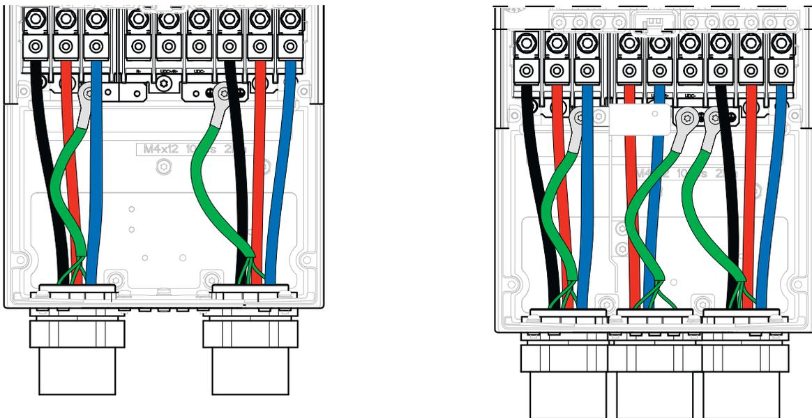
**Figure 4-3 Cable Conduit Installation R6, R7, R8, R9**
