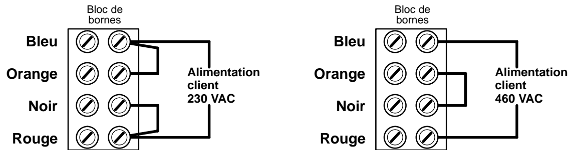
Figure 2-2 Connexions du souffleur 230 VAC/460 VAC (monophasé)
